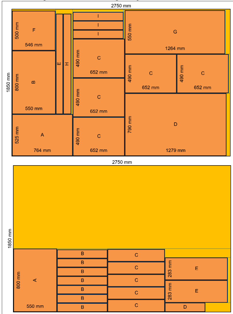
Figura 12: Padrão de corte gerado pelo software Maxcut .
