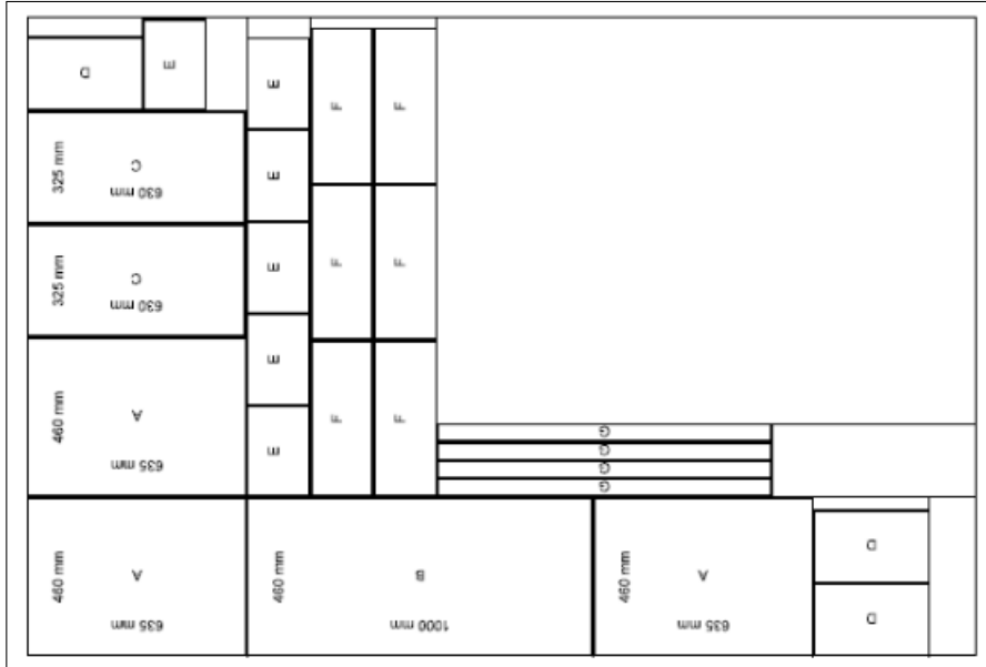
Figura 9: Padrão de corte gerado pelo software Maxcut .
